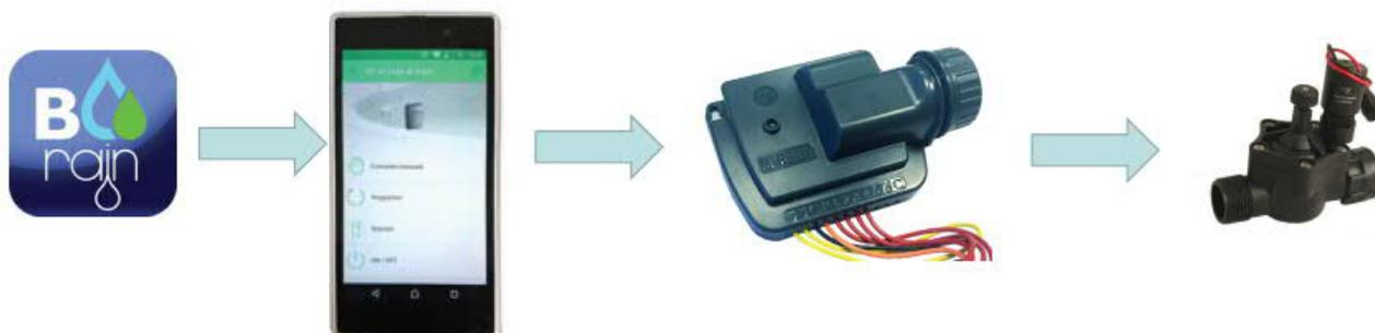
**Distanza massima tra il telefono/tablet e il programmatore 5 m in pozzetto interrato e 15 m per installazione all'esterno**
